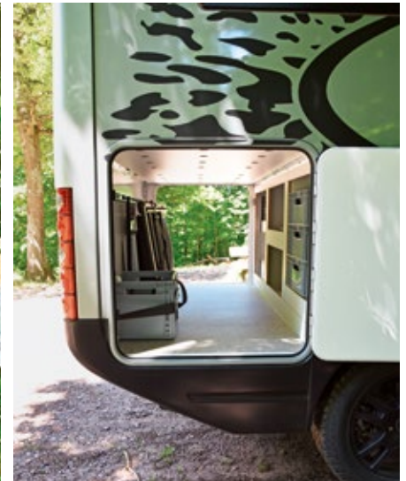
Viel Stauraum: Von links wie rechts gewähren große Türen Zugang zur Garage. Hier passen auch Fahrräder mit demontierten Vorderrädern hinein. Zudem besteht Zugang zum Stauraum unter der Sitzbank.
