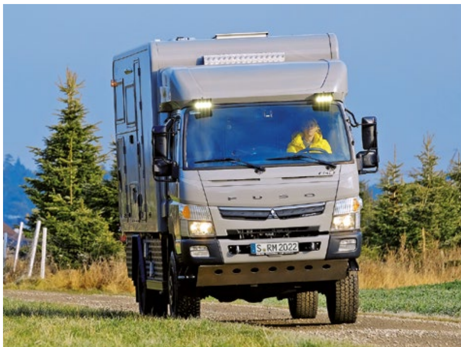
Woelcke Fuso, Modell Autark Camper mit langem 3,8-Meter-Radstand und einer stattlichen Wohnkabine mit 5,15 Meter Bodenlänge. Einzigartig: Woelcke erweitert das Fahrerhaus nach hinten und oben.
