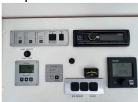
Hauptschalter für 12V Anlage und Wasserpumpe
